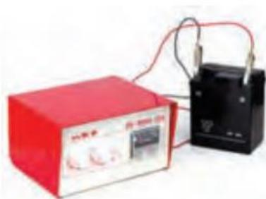
این که باتری ۲ انرژی مصرفی خود را از باتری ۱ تأمین می‌کند، همان اتفاقی است که هنگام اتصال یک باتری به شارژکننده روی می‌دهد. شارژکننده به باتری انرژی الکتریکی می‌دهد. بخشی از این انرژی به انرژی شیمیایی تبدیل می‌شود و بقیه آن در مقاومت درون باتری تلف می‌شود و باتری را گرم می‌کند.
