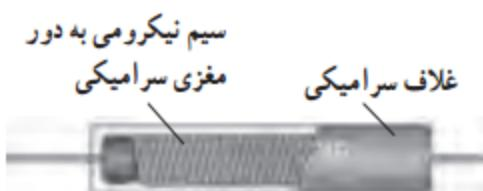
**کاربرد مقاومت پیچه ای:** برای بدست آوردن مقاومت های کوچک بسیار دقیق و همچنین توان های بالا به کار می رود.
