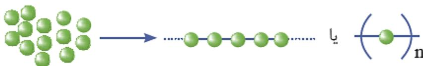
بدیهی است که بر اساس الگوی بالا با تغییر مونومر، پلیمری جدید با ساختار و خواص متفاوت می توان تهیه کرد.
