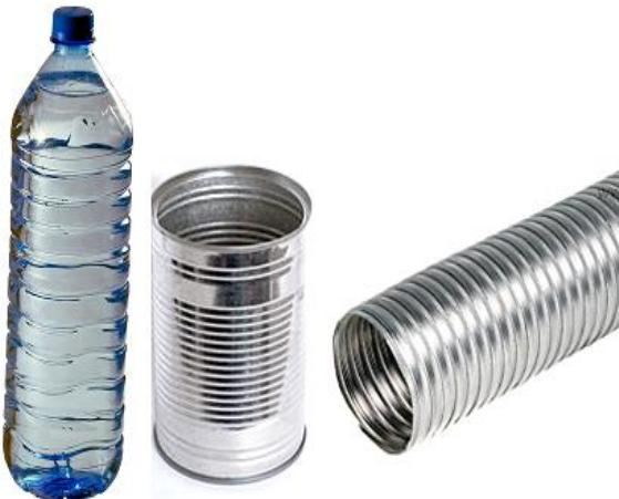
همانطور که می بینید این وسیله ها از ورقه های فلزی یا پلاستیکی نازک تهیه می شوند. اگر این ورقه ها صاف باشند در اثر کوچکترین فشاری تا خورده و تغییر شکل می دهند ولی وقتی روی آن شیار ایجاد می کنیم مانند مقوای آزمایش بالا مقاومت آنها زیاد می شود و دیگر به راحتی تا نمی خورند یا خم نمی شوند.
