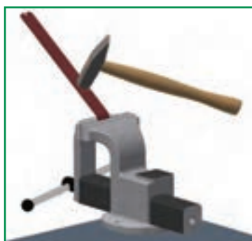
پ - خم کاری با چکش فلزی
