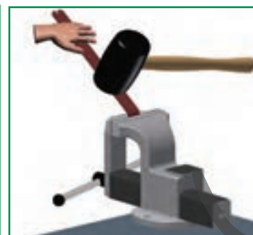
الف - خم کاری با دست و چکش لاستیکی
