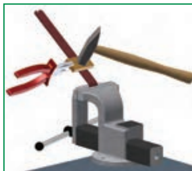
ب - خم کاری با انبردست و چکش فلزی
