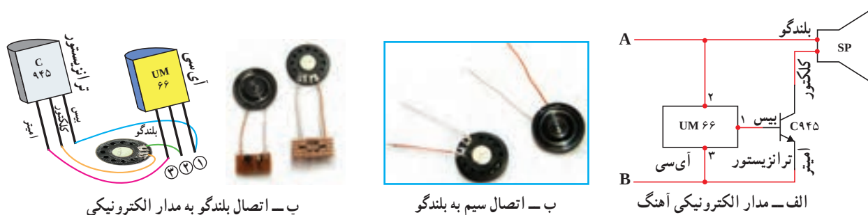
شکل ۲-۲۶ - مدار الکترونیکی جعبه آهنگ
