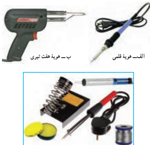
پ- بعضی از تجهیزات لحیم کاری شکل ۲-۱۹- چند نمونه هویه و تجهیزات لحیم کاری
