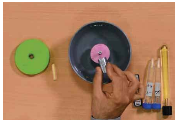
آلومینیم به عنوان یک ماده پارامغناطیس، به آرامی به طرف آهنربای قوی حرکت می‌کند.
