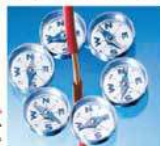
شکل ۳-۳-۱: میدان مغناطیسی اطراف سیم حامل جریان را می‌توان با قرار دادن تعدادی قطره مغناطیسی بر سر آن نشان داد.
